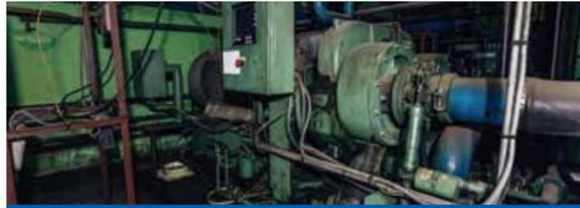
丙烯制冷单元负责为低温甲醇洗提供冷量，同时为低温油洗单元提供冷量。
