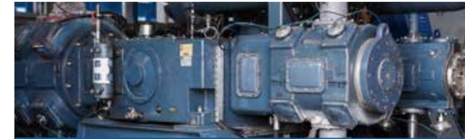
当循环汽中惰性气体含量过多时，释放一部分合成气体，并将其压缩后进行回收处理。
