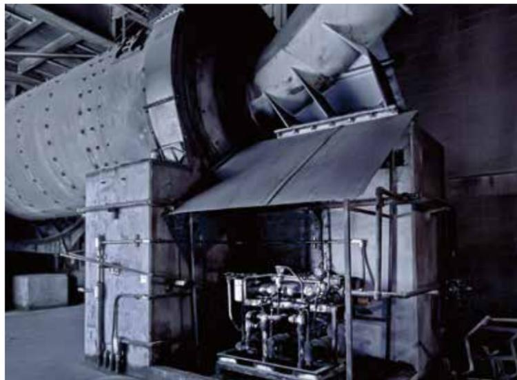
煤、水和添加剂在棒磨机中被研磨成一定粒度分布的浓度约60-65%的水煤浆，经滚筒筛滤去3mm以上大颗粒后，送入煤浆槽。
