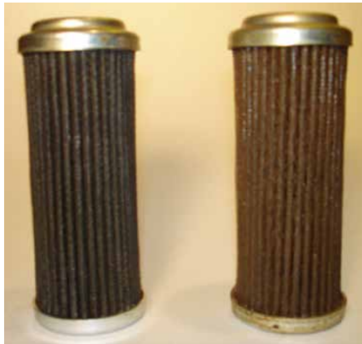
清洁的液压系统过滤器与脏污的液压过滤器
