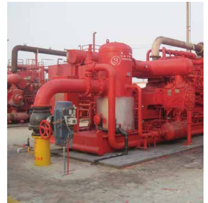
天然气发动机, 卡特皮勒 某油田增压站 中国河南省濮阳市
