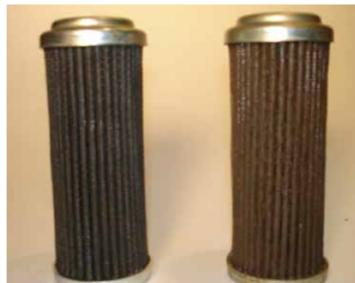
清洁的液压系统过滤器与脏污的液压过滤器
